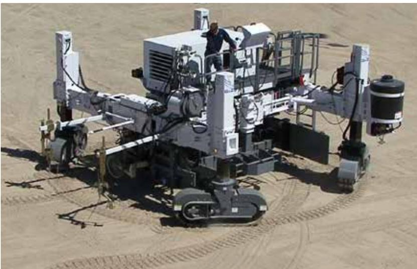
Cuando la pavimentadora S600 está equipada con el sistema AccuSteer opcional, el operador podrá reorientar rápidamente las orugas de la S600 en posición de contra rotación y girar la máquina 360 grados en un espacio limitado. La contra rotación es uno de los numerosos modos de accionamientos preprogramados de la pavimentadora S600, junto con la dirección coordinada y diagonal, dirección en ruedas delanteras y traseras.
