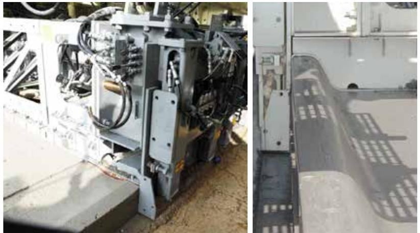
Las secciones de la terminal final en el molde de pavimentación se proporcionan con ajuste de bordes para ayudar a compensar la caída del concreto del borde. Las terminales finales pueden sustituirse por otras secciones cruzadas de moldes de bordillos y bordillos integrales.
