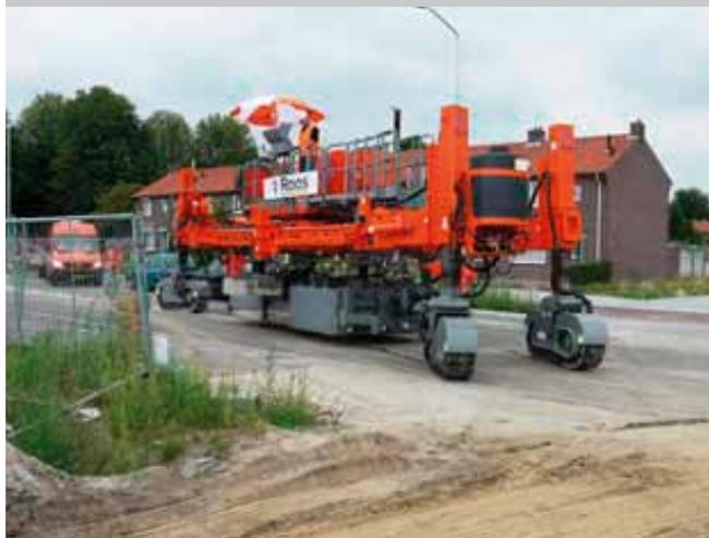
Debido a la velocidad a la cual puede colocarse la pavimentadora S600 en modo de transporte utilizando el sistema AccuSteer/SmartLeg, se recomienda colocar la máquina en modo de transporte para maniobrar alrededor de un lugar de trabajo cuando el espacio para desplazarse sea limitado.
