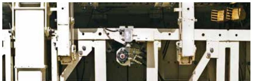
La sección en coronamiento opcional del molde de pavimentación se suministra con potencia por un motor hidráulico y sistema de doble sin fin que, sostiene en posición sin variación. No es necesaria ninguna conexión estructural entre la sección y el bastidor de la pavimentadora. En la consola del operador aparece una lectura digital del ángulo de coronamiento, existe también la opción de un sistema informático computarizado de control de transiciones.
